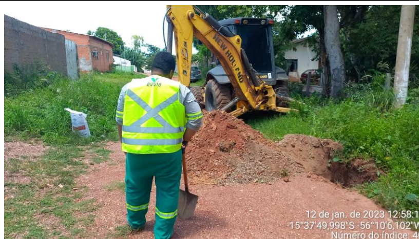
Coleta dos furos de sondagem
